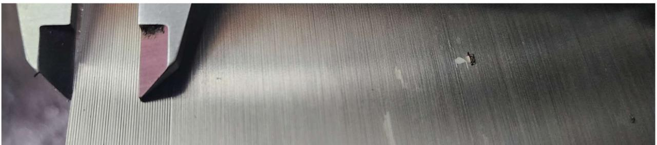
El calibrador tiene una apertura de 10.0 mm y muestra una rugosidad de N8 (3.2  $\mu\text{m}$ ), a la derecha es N6 (0.8  $\mu\text{m}$ )
