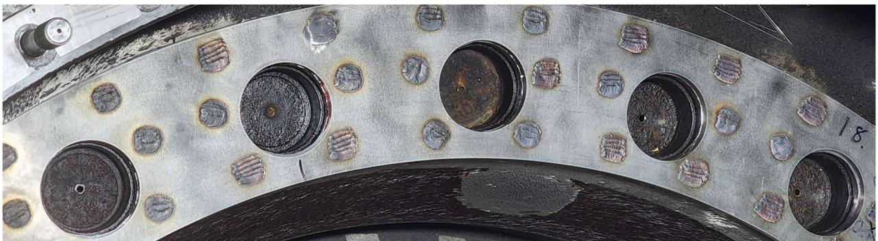
Nueva placa de desgaste, con los pernos de anclaje ya con la soldadura de sellado y parcialmente esmerilados...
