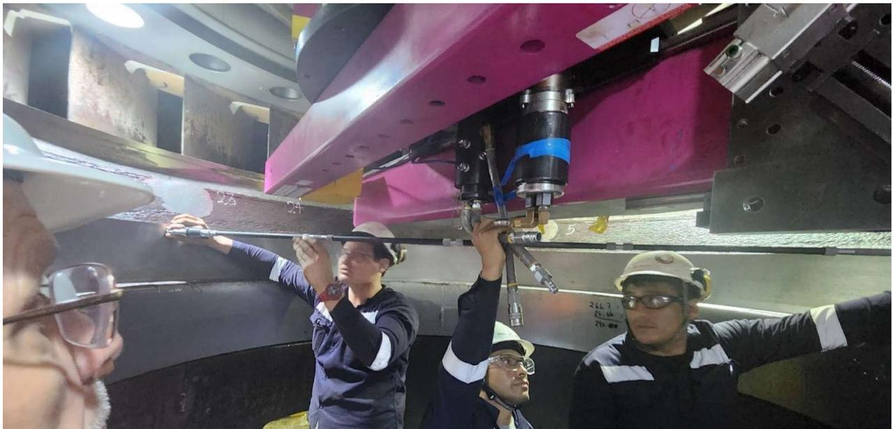
Medición del diámetro de 2,232 mm – con una exactitud de +/- 0.04 mm ...
